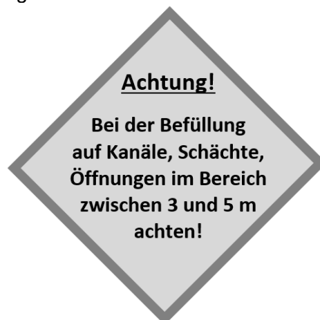
Bild: Beispiel Kennzeichnung Füllanschluss (roter Rahmen, gelber Hintergrund, schwarze Schrift, Mindestgröße 10 cm x 10 cm)
