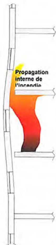
Figure 10 : Propagation interne de l'incendie (Risque de déformation entre les fixations)
